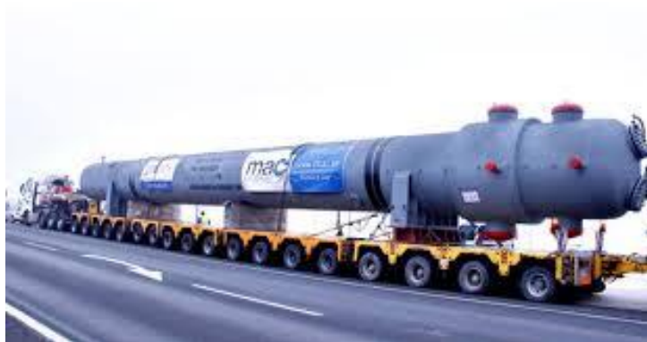
Figura 14 – Trocador de calor usado no sistema óleo e sal. (Fonte: http://www.mac-tpi.com/ )
